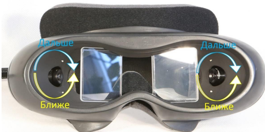
Рис. 17. Направление вращения объектива для удаления или приближения границ резко изображаемого пространства
